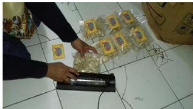
Gambar 1. Proses pengemasan menggunakan hand sealer
