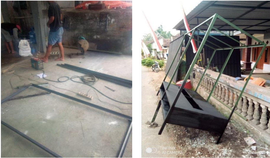
Gambar 7. Proses perangkaian kandang BSF di mitra Bank Sampah Eltari
