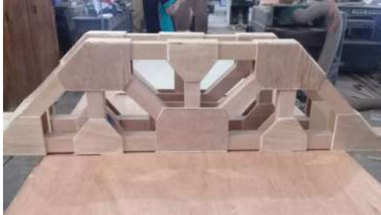
Gambar 5.7 Pemasangan sambungan titik buhul pada jembatan box beam kayu Kamper
