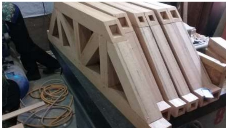
Gambar 3. Perbandingan Penampang Balok Solid dan Box Beam dengan Luas Penampang Sama (Sumber : dokumentasi eksperimen)
