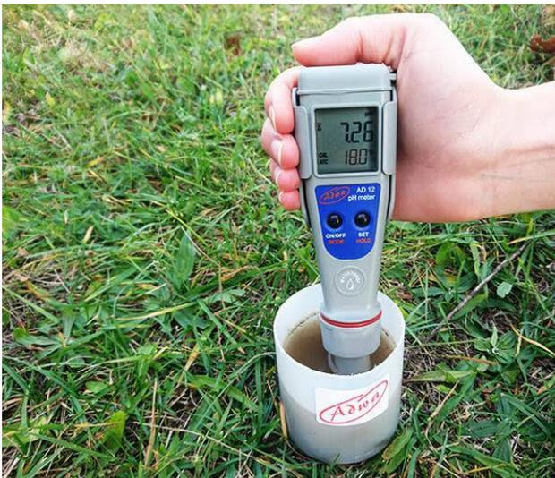
**Gambar 5.1 Mengetahui pH tanah sangat penting dalam persiapan proses bioremediasi**
