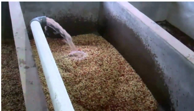
Gambar 3.1 Pembersihan bahan menggunakan wet method.
